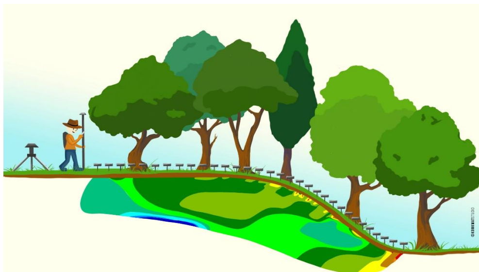
Fig. 6. Tomographie électrique en milieu forestier avec relevé d'altitudes.
