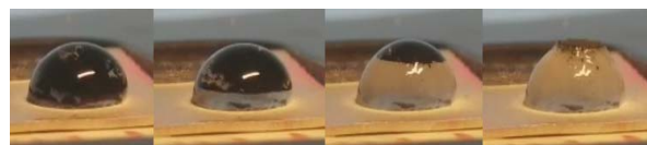
Fig. 9. Water + GNF (5%), t_{\text{freeze}} = 1\text{min } 35\text{s} \pm 3\text{s} .
