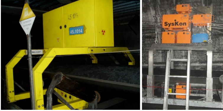
Fig. 5. SysKon400, system ciągłej kontroli parametrów jakościowych węgla w LW “Bogdanka” S.A.
